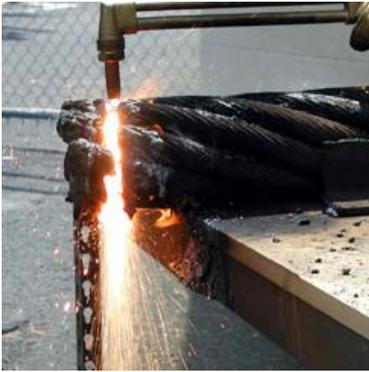
Sistema de Oxy-Corte con gasolina. Aprobado para trabajar en Centrales Nucleares y minería. Aprobado por la OSHA, US Navy, US Cost Guard, Lloyd's Register of Shipping, certificado GS por BAM[Alemania]
